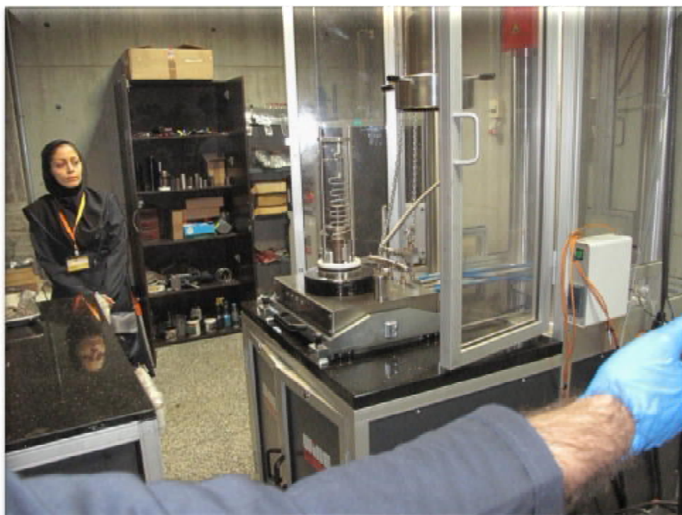
آزمایشگاه آنالیز مغزه شرکت میپصا: دستگاه تست ژئومکانیکی با شبیه سازی مخزن (گروه ۱ و ۲)
